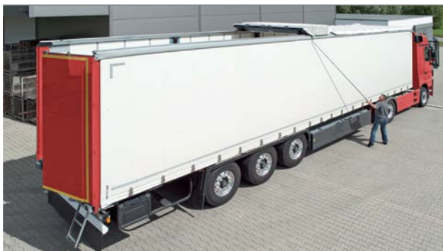
Снятие крыши на примере CS-Hybrid
